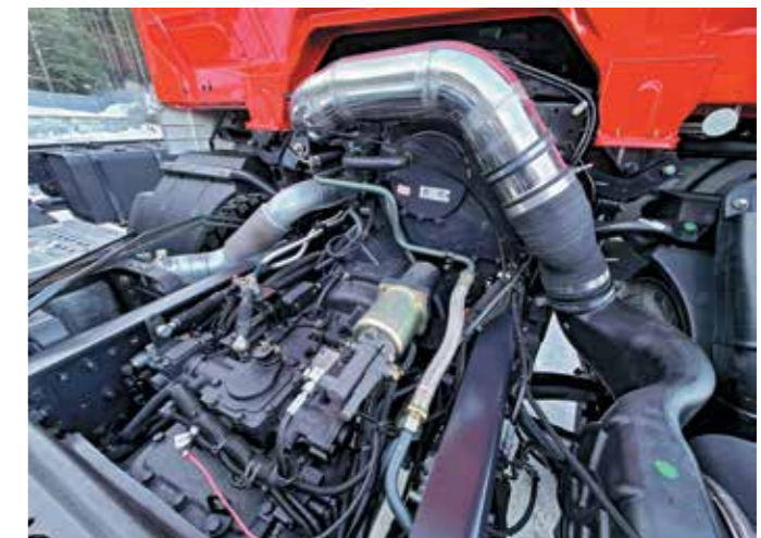
Cursor'ы работают в паре с 12-ступенчатыми механическими коробками передач Fast Gear с двойным промежуточным валом. В стандартном исполнении КП крепится на пяти опорах. Причем пятая опора на усиленной поперечине без выступающих за габариты рамы элементов, что упрощает монтаж надстроек
