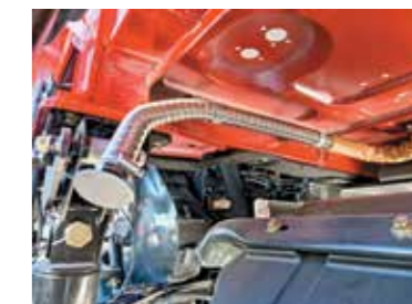
Предпусковой подогреватель входит в стандартное оснащение миасских грузовиков. В качестве опции можно установить и независимый отопитель кабины
