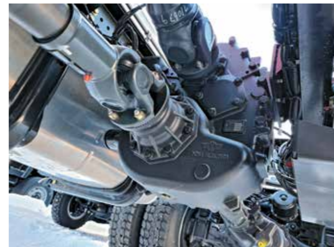
Раздаточные коробки, аналоги ZF VG2000/300, несут клеймо Zhuzhou Gear Co., Ltd., дочерней компании Weichai Power. Кстати, вариантов отбора мощности у Hongyan'ов три: от двигателя, коробки передач и раздаточной коробки
