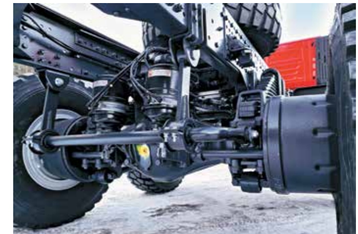
В стандартном исполнении используются задние мосты, рассчитанные на нагрузку 16 т. Но есть в линейке и 20-тонные модели
