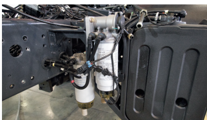
Тут стоят сразу два фильтра с водоотделителем
