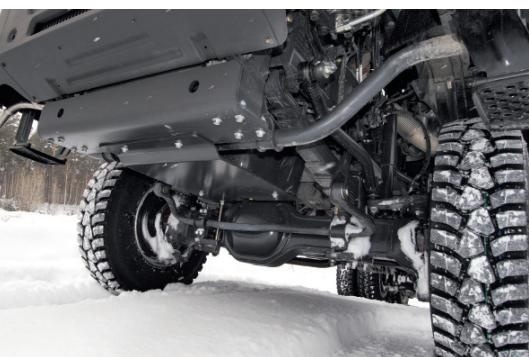
Под передним бампером стальная защита, клиренс больше, чем у IVECO
