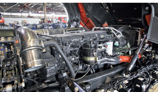
Под кабиной лицензионный двигатель мощностью 480 л.с.
