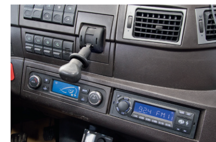
Ручник вынесен на панель, ниже управление «климатом» и магнитола
