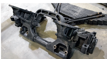
Китайская поперечина балансира усилена
